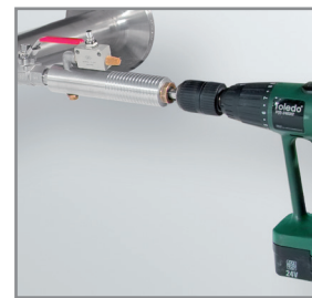
Borrning under tryck med CS borrarordning
