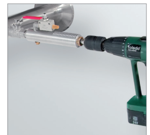
Borrning under tryck med CS borrarordning
