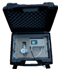
Misura della qualità dell'aria compressa
